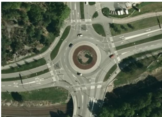
MYND 18 Loftmynd af tvíbreiðu hringtorgi í Svíþjóð þar sem miðeyjur eru á milli akreina í sömu akstursstefnu og akreina í sitthvora akstursstefnuna (Tekið af vef eniro.se)
